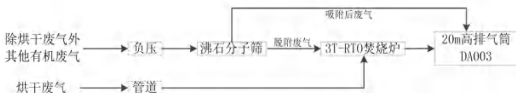
图 4.4-1 项目废气处理装置工艺流程示意图
