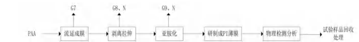
图 3.2-21 高温薄膜溶液浇铸试验工艺流程及产污位置图
